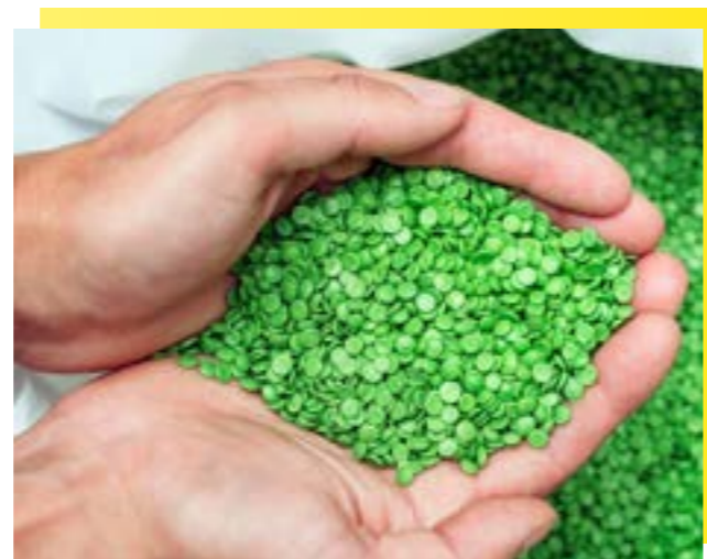
Regranulat (Rezyklat) aus biologisch abbaubarem Kunststoff
