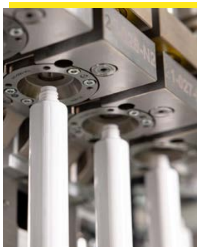
Produktion von PE-basierten Monomaterialtuben auf PackSys Maschinen
