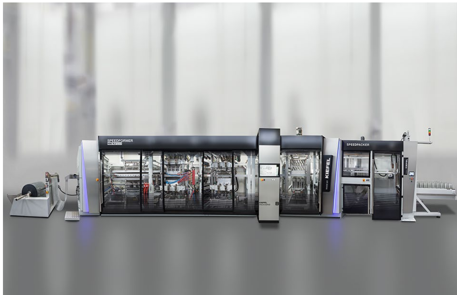
Effiziente und nachhaltige Produktion von Polymerschalen mit der KMD 78.2 SPEED Maschine. © KIEFEL GmbH
